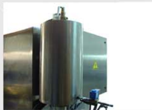
El calderín independiente permite un control total del porcentaje de humedad. Opcional para calentamiento eléctrico.
