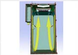
Circuito de reparto de calor de diseño propio, asegura una cocción homogénea en toda la cámara.
