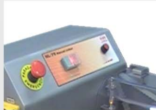
4 patrones de intervalo entre atados para adaptarse a todo tipo de productos. Un led luminoso indica el modo activado.
