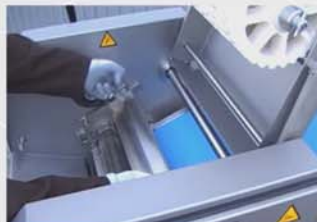
La extracción fácil y rápida del portacuchillas minimiza los tiempos de cambio de cuchilla.
